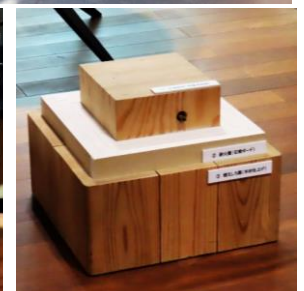
この 1 階柱のみ 3 時間耐火構造
